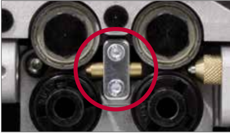
Entegre gaz akış sensörlü Frontpull 8 Modülü
