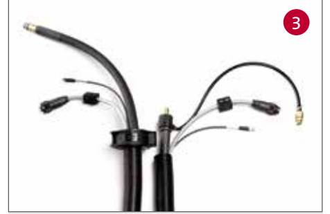
Bağlantı braketinden tel sürme ünitesi PF5'e bağlantı
